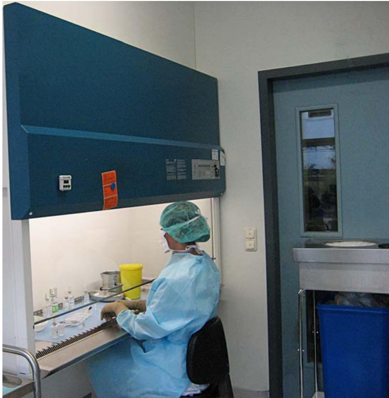
Abbildung 2: Zubereitung von anwendungsfertigen Zytostatikallösungen in einer Sicherheits-Werkbank (DIN 12980)
