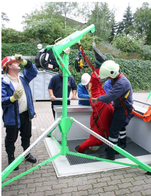
Bild 2: Beispiel einer Rettungsübung: Herausziehen der Person mittels einer an einem Dreibein befestigten maschinell angetriebenen Rettungswinde
