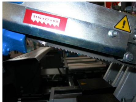
Bild 1: Unzureichender Schutz über dem Sägeblatt
