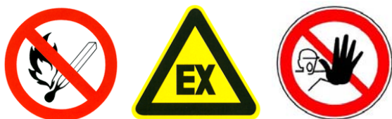
Bild 1: Verbotsszeichen „Feuer, offenes Licht und Rauchen verboten“, Warnzeichen „Warnung vor explosionsfähiger Atmosphäre“ und Verbotsszeichen „Zutritt für Unbefugte verboten“ (gem. BGI 740, Ausgabe 04/2006)
