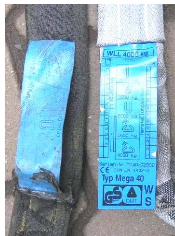
Abb. 4 – Rundschlingen: links: Kennzeichnung nicht mehr lesbar!
