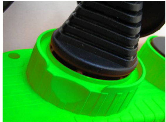
Abb. 2: Steckverbindung mit unzulässigem Spalt
