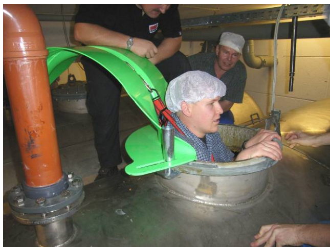
Bild 1: Sicherer Einstieg in einen Behälter mittels einer Rettungsrutsche
