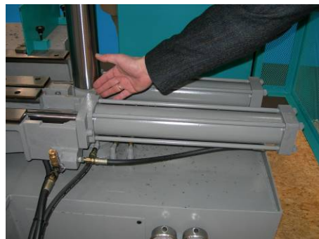
Bild 2: Zugriff in den Gefahrenbereich an der Materialzuführung möglich
