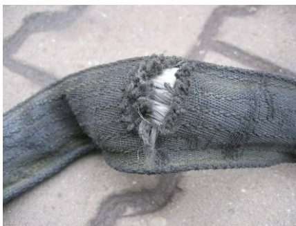
Abb. 3 – Rundschlinge: Beschädigte Hülle als Zeichen für Ablegereife
