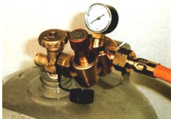
Abb. 5: Leckgassicherung: erforderlich bei Arbeiten unter Erdgleiche. Diese erkennt kleinste Undichtigkeiten in der äußeren Schlauchwand des doppelwandigen Schlauches sofort und löst einen sofortigen Stopp des Gasflusses aus. Explosionsschutzmaßnahme!
