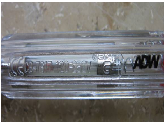
Abb. 2: Vorgeschriebene Kennzeichnung für Spannungsprüfer
