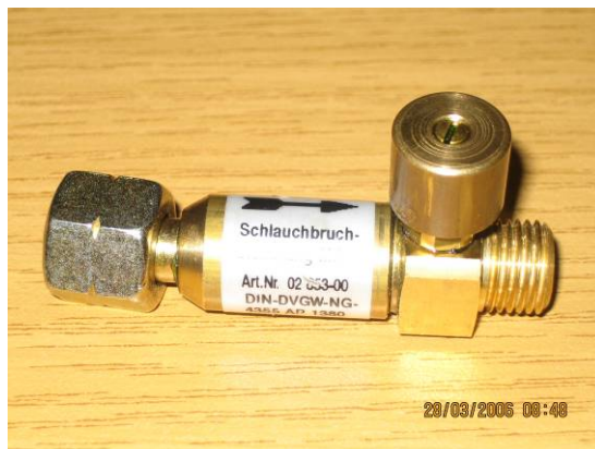
Abb. 4: Schlauchbruchsicherung: erforderlich bei Arbeiten mit brennbaren Gasen über Erdgleiche. Diese schließt die Gaszufuhr, sobald ein starker Druckabfall im Schlauch registriert wird. Explosionsschutzmaßnahme!
