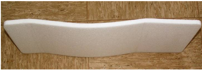
Verformung im Bodenteil einer Baby-Tragetasche nach Belastung
