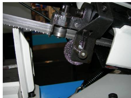
Bild 3: Bürste zum Reinigen des Sägeblattes ohne Schutzeinrichtung
