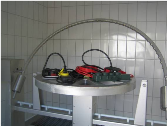
Abb. 3: Prüfung von IP44-Steckdosenleisten
