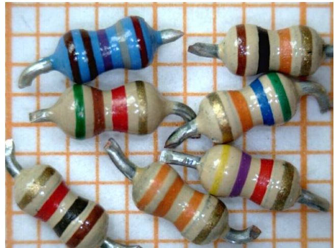
Bild 2: Probedokumentation von Widerständen vor dem Homogenisieren
