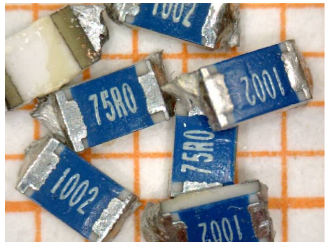
Bild 3: Darstellung von kleinsten demontierten Bauteilen mit Hilfe einer Mikroskopkamera
