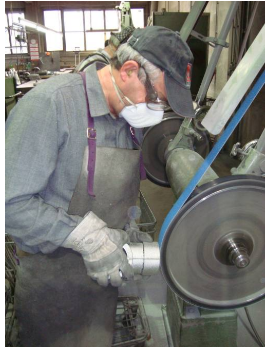
Abb. 3 Metallbearbeitung mit Schleifmaschine Beispiel für Einleitung von Vibrationen in das Hand-Arm-System über das Werkstück
