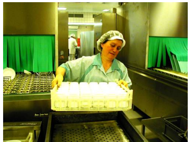
Abb. 7: Unergonomisch gestalteter Arbeitsplatz an einer Spülstraße
