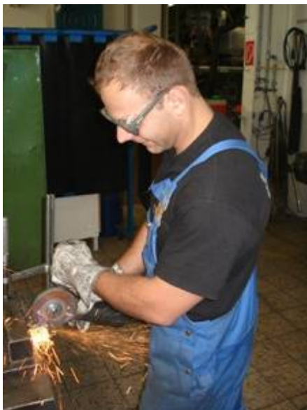
Abb. 1 Metallbearbeitung mit Winkelschleifer Beispiel für Hand-Arm-Vibrationen
