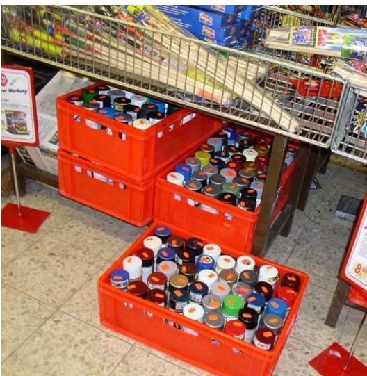
Abb. 4: Unzulässig: Feuerwerksartikel im Verkaufsraum direkt neben leicht brennbaren Stoffen (Lackspraydosen)
