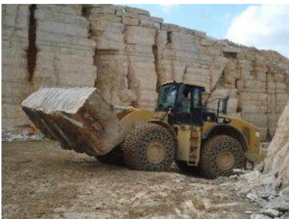
Abb. 2 Transport eines Marmorblockes im Steinbruch Beispiel für Ganzkörper –Vibrationen
