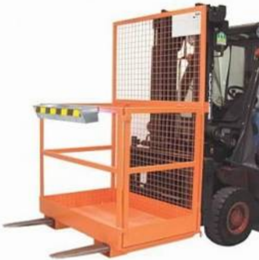
Bild 2: Für die Verwendung an Gabelstaplern zugelassene Arbeitsbühne
