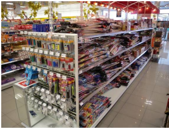
Abb. 5: Ein häufig auffindbarer Mangel: Feuerwerksartikel direkt neben leicht brennbaren Stoffen (hier: Gasfeuerzeuge)
