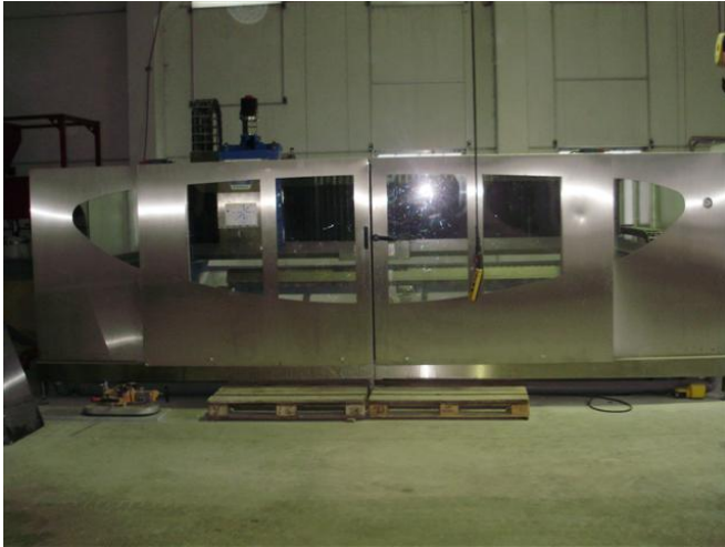
Bereichssicherung an der Beschickungsseite
