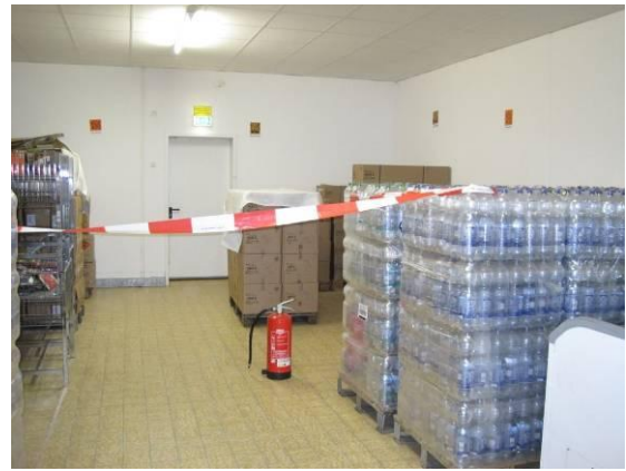
Abb. 2: Optionale Brandschutzmaßnahmen: Vergrößerter Abstand und zusätzliche Abschirmung durch unkritische Gegenstände (hier: Wasserflaschen)
