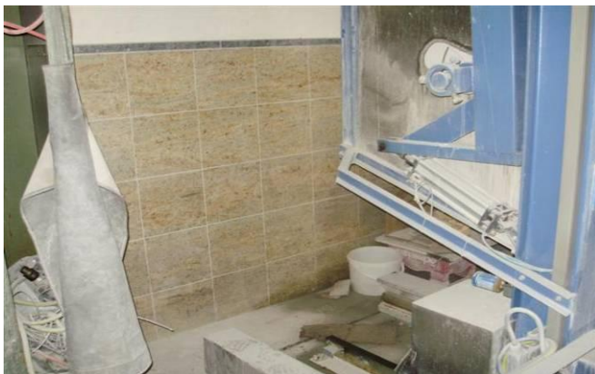
Quetschstelle zwischen Schlitten und Hallenwand
