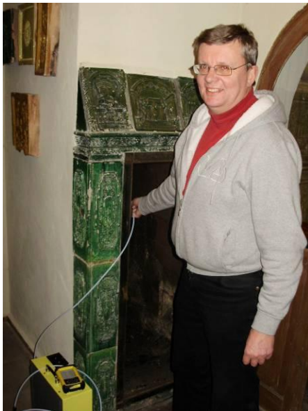
Bild 9: Sulfuryldifluorid-Messung am Kamin nach Freigabe der begasteten Räume
