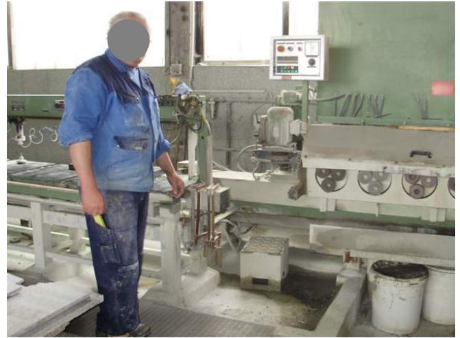
Quetschstelle, solange Schlitten in die Werkbank einfährt
