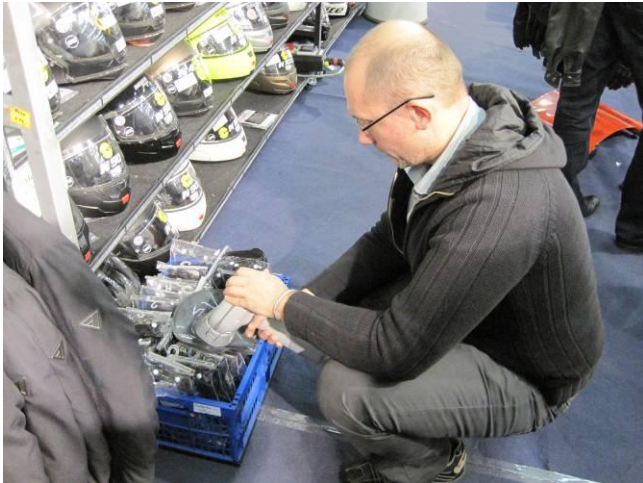
Abbildung 8: Untersuchung mittels RFA-Messgerät vor Ort
