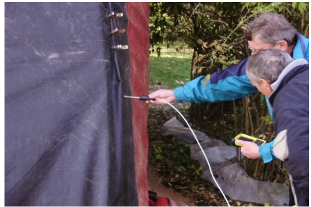
Bild 6: Sulfuryldifluorid-Messung unmittelbar an der Plane
