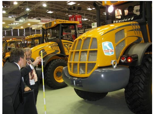
Orientierende Überprüfung der Sichtverhältnisse
