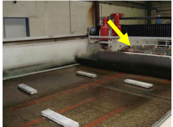
Blick auf die automatische Kopfwechseleinrichtung (der Pfeil zeigt auf die Reißleine)
