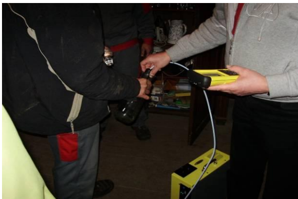
Bild 10: Sulfuryldifluorid-Messung in einer Glaskaraffe
