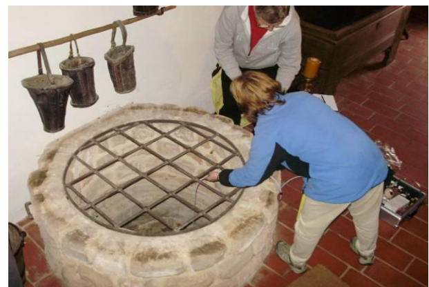
Bild 8: Sulfuryldifluorid-Messung am Schachtbrunnen nach Freigabe der begasteten Räume
