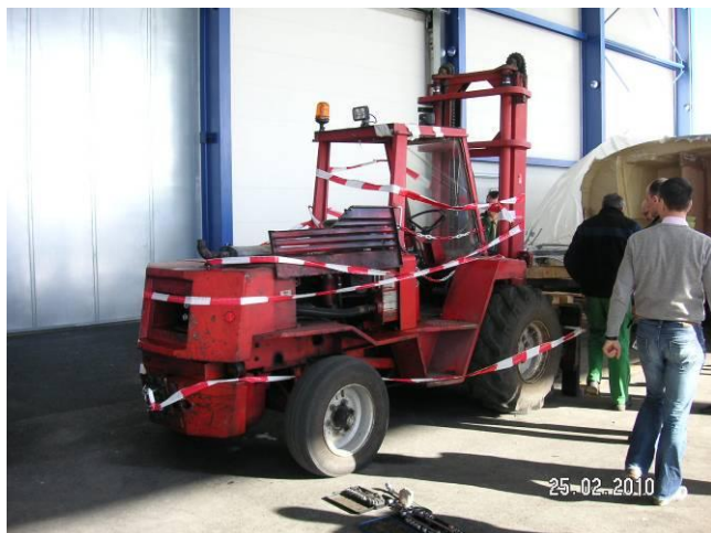
Bild 1 Gabelstapler, dessen polysulfidhaltiges Getriebeöl sich zersetzt hatte und dadurch bei über 40 Beschäftigten Gesundheitsbeschwerden verursachte
