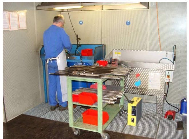
Abbildung 9: Gefahrstoffmessung am Arbeitsplatz mit direkt anzeigendem Infrarotspektrometer und Probenahme mit Aktivkohleröhrchen
