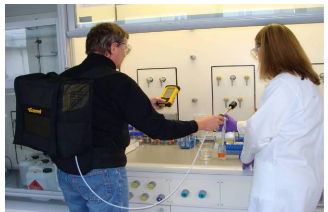
Abbildung 10: Gefahrstoffmessung am Arbeitsplatz mit direkt anzeigendem Infrarotspektrometer
