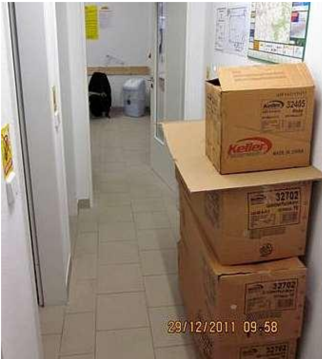
Abb. 5: Eng: Unzulässige Aufbewahrung im Verkehrsweg
