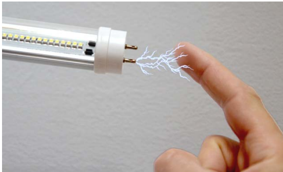
Elektrische Gefährdung durch LED-Röhren (Bild: GAA München)
