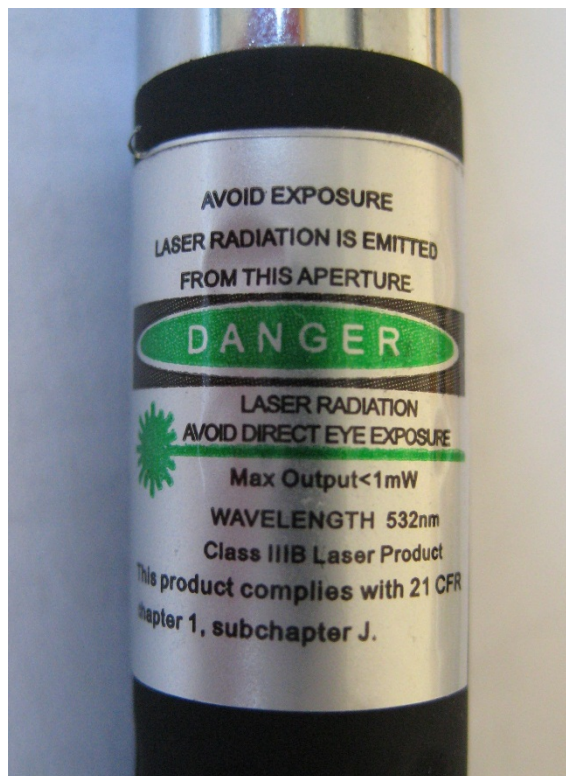
Fehlerhafte Leistungsangabe, Warnhinweis in englischer Sprache, auf Grund der Schriftgröße kaum lesbar (Foto: Regierung von Unterfranken)
