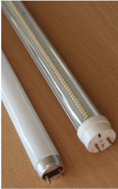
Herkömmliche T8 Leuchtstoffröhre (links) neben moderner LED-Röhre. (Bild: GAA München)
