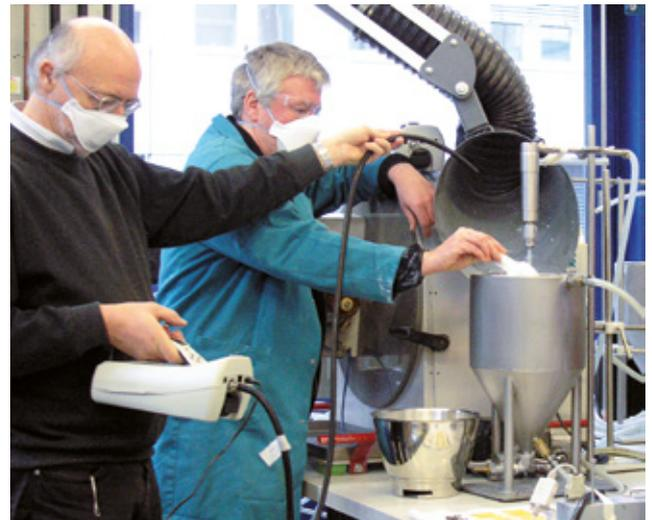
*Abbildung 9: Expositionsmessungen zur Bestimmung der Partikelbelastung in der Raumluft*
