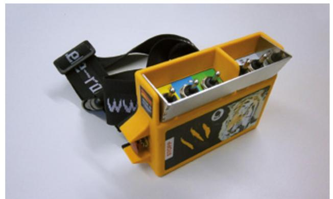
Abbildung 3: Sender einer Funkfernsteuerung mit Not-Aus-Schalter und bediensicheren Kippschaltern
