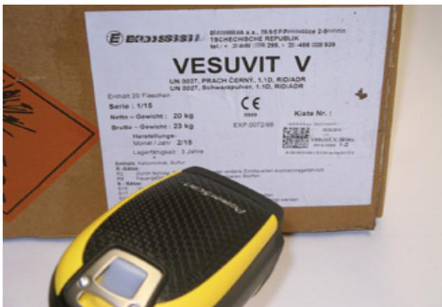
Abbildung 15: Scannen eines Matrixcodes
