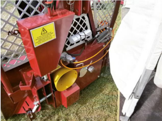
Abbildung 4: Standardisierte Steckdose für die Fernsteuerungsempfänger an der Seilwinde
