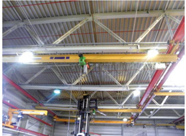
Abbildung 2: Unten an Kopfträgern angeschraubte Brückenkräne
