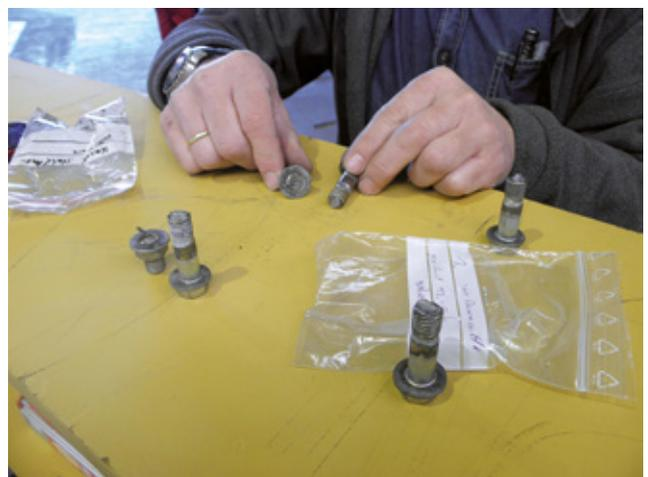
Abbildung 3: Abgerissene Kranschrauben
