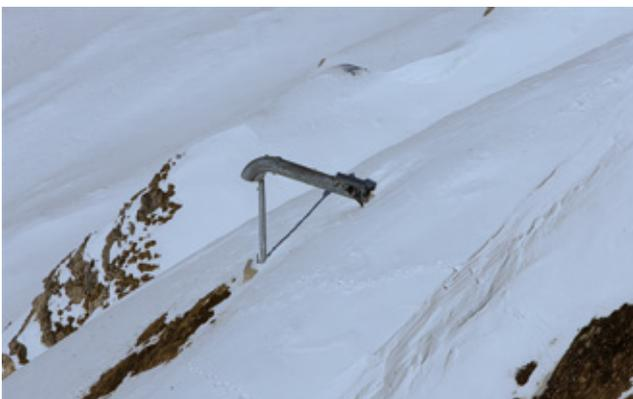
Abbildung 2: Umlenktrichter für kontrollierte Verpuffungen von Flüssiggas-Luftgemischen
