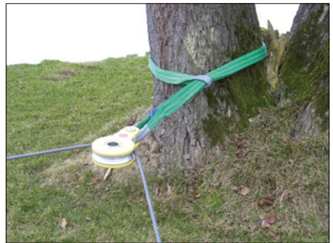
Abbildung 5: Umlenkrolle im Forsteinsatz
