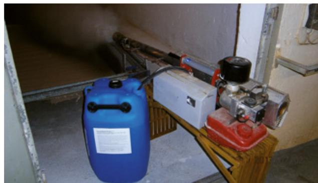
Abbildung 8: Formaldehydeingasung mit Hilfe eines Verneblers
