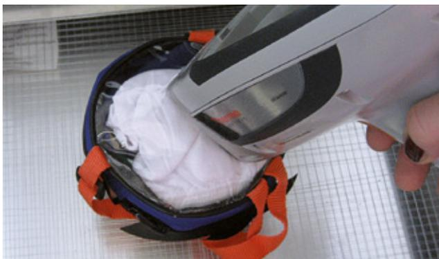
Abbildung 16: Analyse mit dem RFA-Gerät
