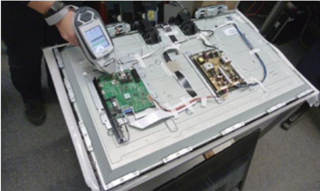
Abbildung 14: Messung an einem Flachbildfernseher
