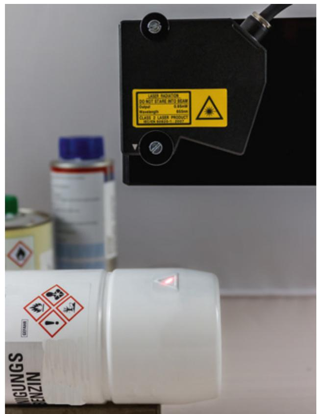
Abbildung 2: Messaufbau zur Höhenbestimmung von tastbaren Gefahrenhinweisen
