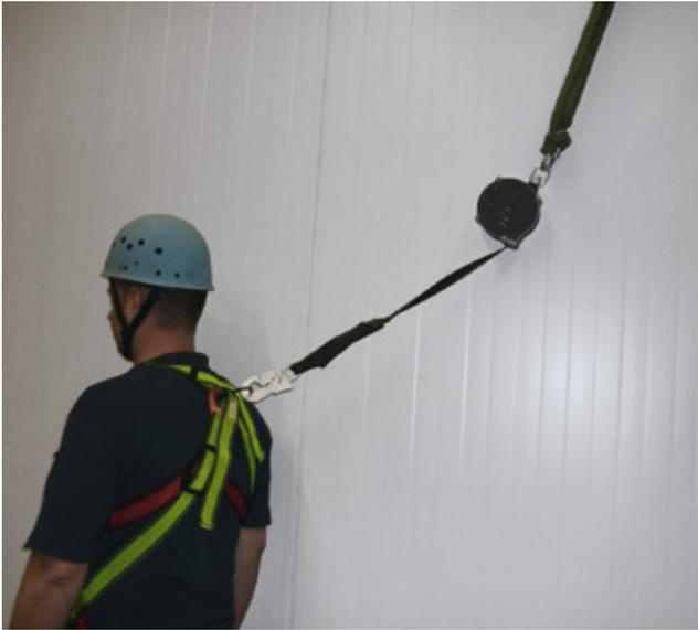
Abbildung 15: Persönliche Schutzausrüstung mit Höhengsicherungsgerät
