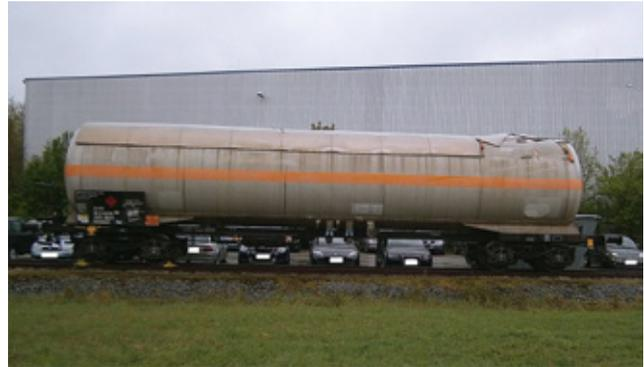
Abbildung 6: Beschädigter Druckgaskesselwagen
