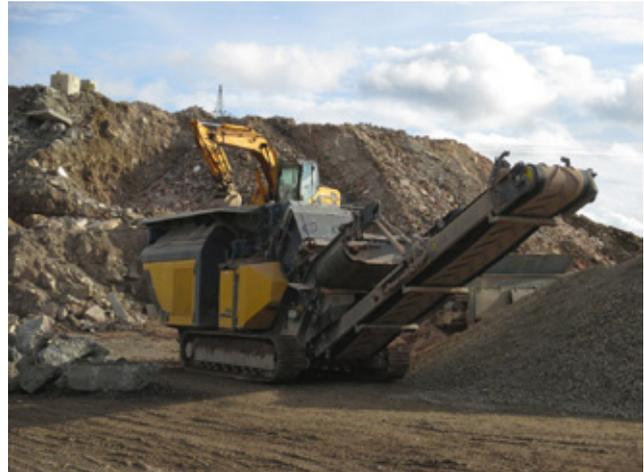
Abbildung 10: Ortsbewegliche Bauschuttrecyclinganlage
